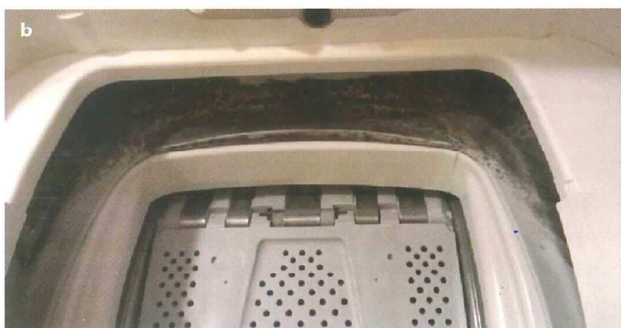
3. kép: Pangó víz (a) és gombatelepek (b) mosógép gumitömítésén
